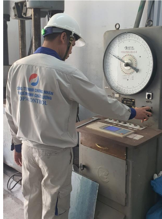
Máy kéo thép vạn năng WE-1000B gắn đầu đọc điện tử
